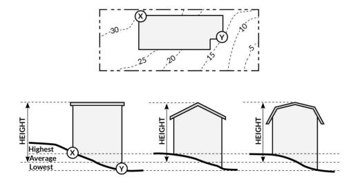
FIGURE 18.02.030.C: MEASURING BUILDING HEIGHT
